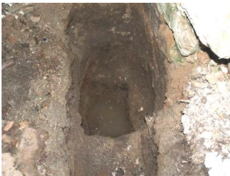
Podzemní voda v sondě K1
